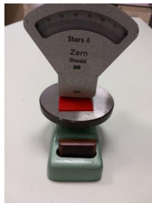
Slika 2: Mjerenje tvrdoće na uređaju Zorn Stendal
