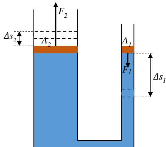
**Slika 8.2.** Princip rada hidrauličnih uređaja
