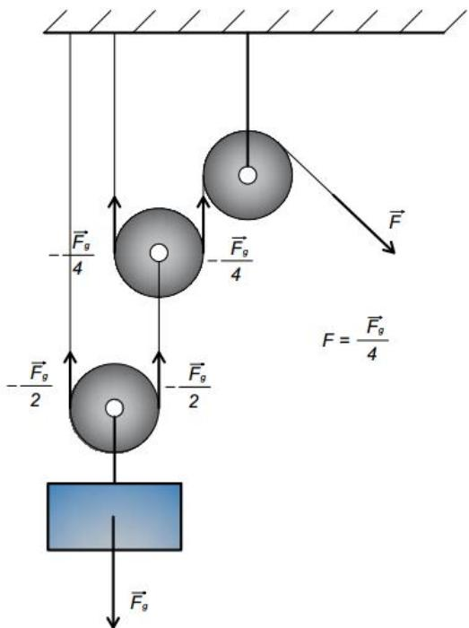
Na slici 5.20. prikazan je koloturnik s dva pomična i jednim nepomičnim koloturom.
