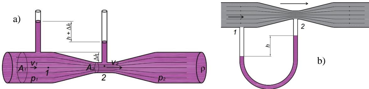
**Slika 8.17.** Venturijeva cijev, a) protok tekućine, b) protok plina
