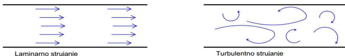
**Slika 8.12.** Laminarno i turbulentno strujanje
