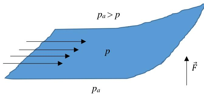
**Slika 8.21.** Princip avionskog krila
