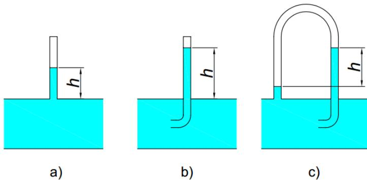
**Slika 8.16.** Mjerenje tlaka: a) statičkog, b) hidrodinamičkog, c) dinamičkog
