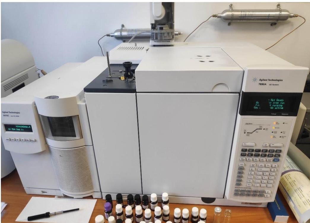
**Naziv uređaja:** GCMS (plinski kromatograf / spektrometar masa)
