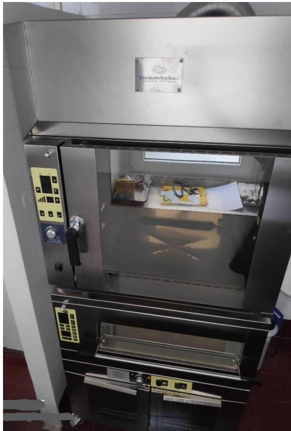
**Naziv uređaja:** Pekarsko pilot postrojenje (fermantacijska komora / etažna pećnica, konvekcijska peć / kondenzacijski sakupljač pare / omekšivač vode)
