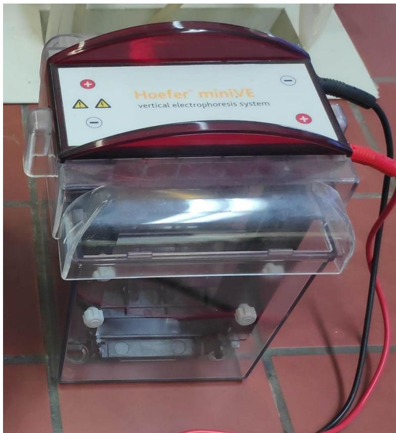
**Naziv uređaja:** Vertikalna jedinica za elektroforezu
