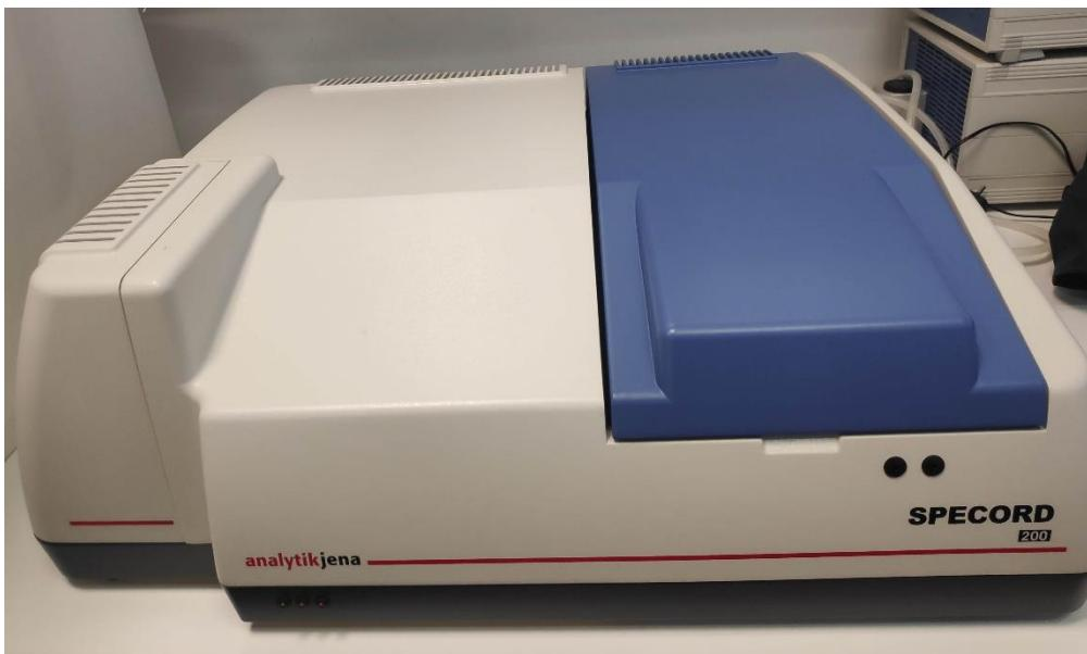
**Naziv uređaja:** Spektrofotometar dvozračni
