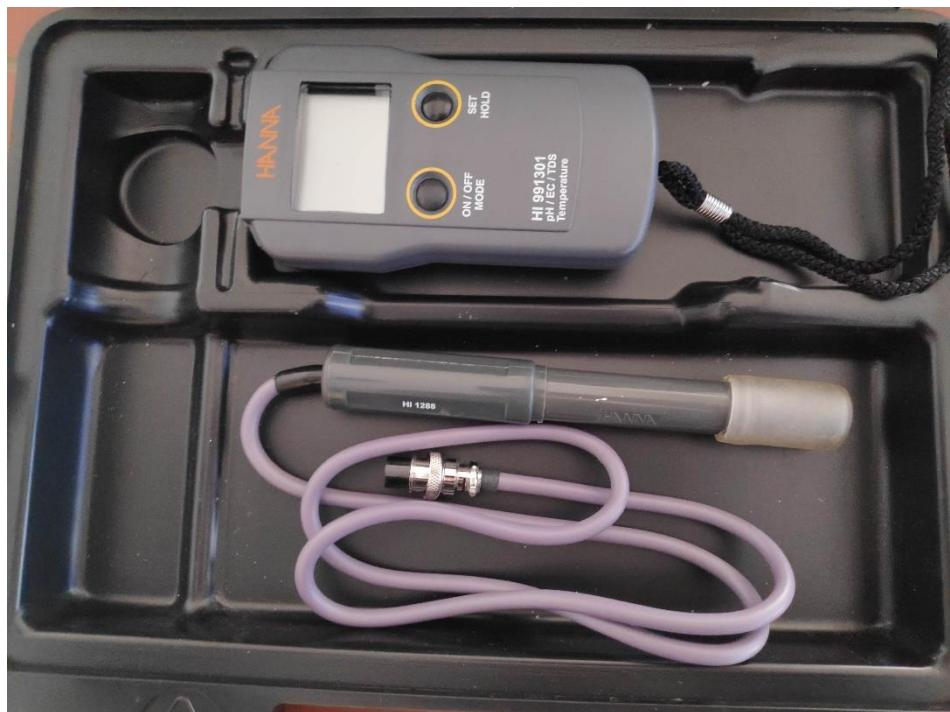
**Naziv uređaja:** Prijenosni mjerač provodljivosti, ukupno otopljenih krutina, pH i temperature
