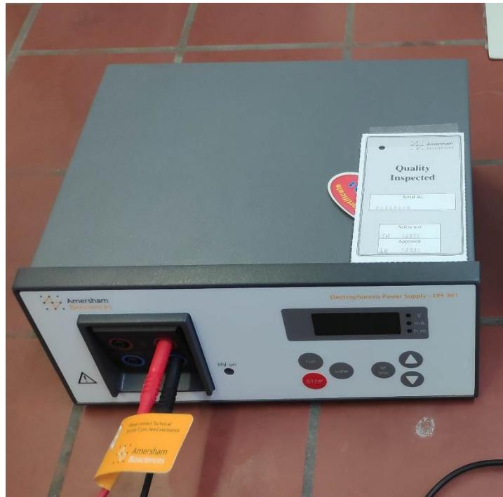
**Naziv uređaja:** Napajanje za elektroforezu
