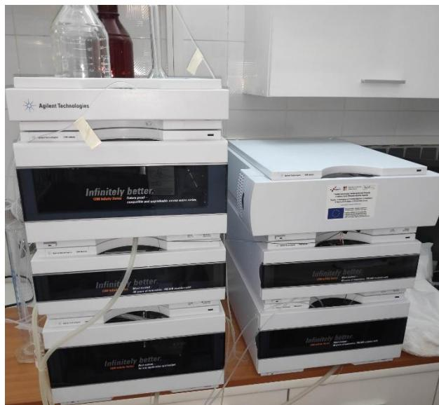
**Naziv uređaja:** HPLC Tekućinski kromatograf visoke učinkovitosti
